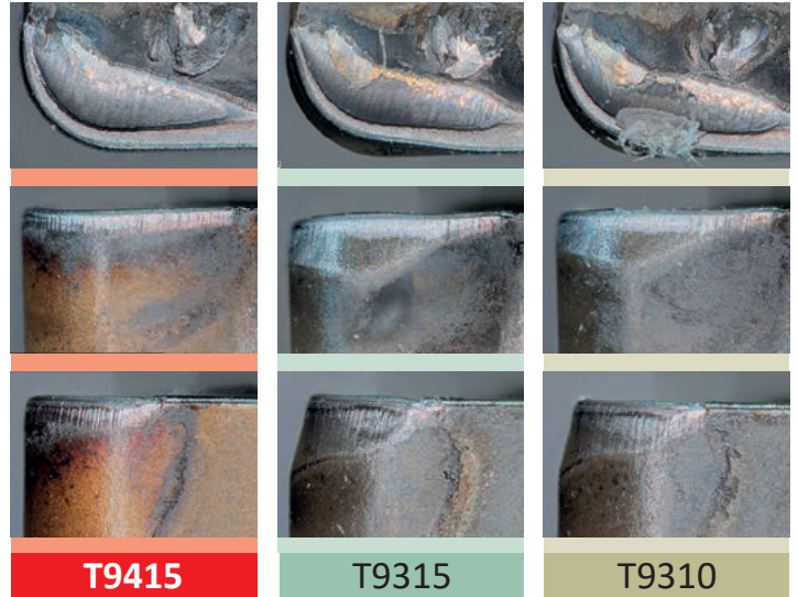
Fotos von kontinuierlichen Schneidvorgängen. Alle nach 16 Minuten aufgenommen.
