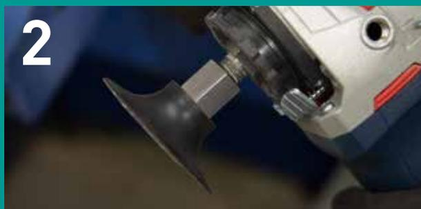
So können Sie auf Ihrem 3/8-24 oder 5/8-11 Winkelschleifer Stützteller mit TR oder TS Verschluss einsetzen.
