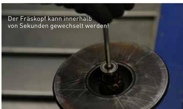
Der Fräskopf kann innerhalb von Sekunden gewechselt werden!
