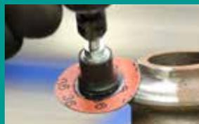
**TIPP** Verhindern Sie das Ausfugen von Konturen indem Sie einen Halter mit einem kleineren Durchmesser als den der Scheibe verwenden, das heißt einen 38 mm Halter für 50 mm Scheiben.
