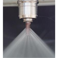
Unabhängig vom Haltertyp, Kühlung erfolgt durch das Werkzeug.
