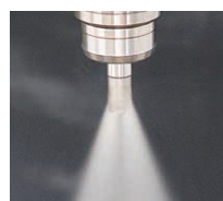
Typ D Kühlmittelzufuhr durch das Zentrum
