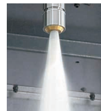
Peripheriekühlung ohne PS-Ring
