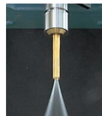
Kühlmittelzufuhr durch das Zentrum mit PS-Ring
