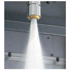
Peripheriekühlung ohne PS-Ring
