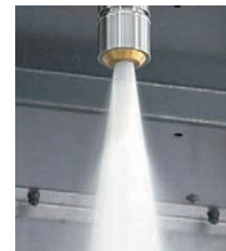
Peripheriekühlung ohne PS-Ring
