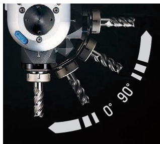
Kinderleicht einstellbarer Spindelwinkel von 0° bis 90°.
