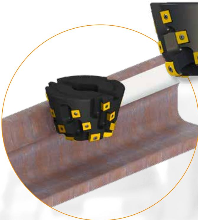
**Konische Aufsteckfräser für die Bearbeitung der Laufseite von Zungenschienen**
