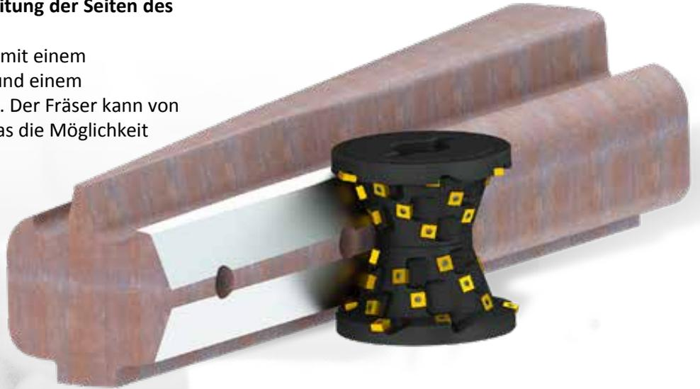
**Spezial-Profilfräser für die Bearbeitung der Seite und der Unterseite des Kreuzungsblocks**
