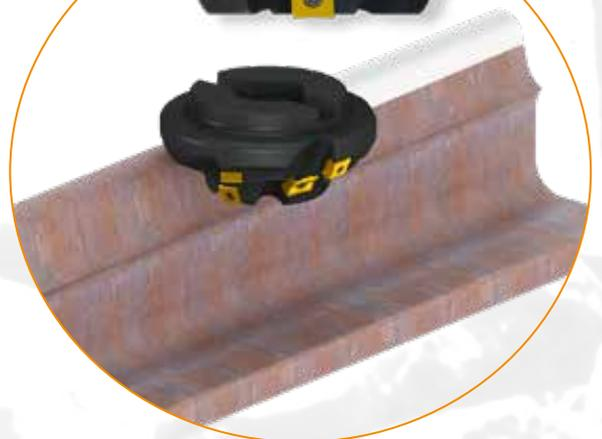
**Fräser für die Bearbeitung des Radius R13 und der Wandschrägen von beiden Seiten**
