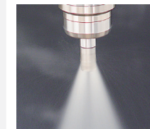
Typ D Kühlmittelzufuhr durch das Zentrum
